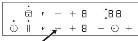
Toque simultaneamente em **+** e **-** da zona de cozedura correspondente para desactivar essa zona de cozedura. A definição volta a **0**.
