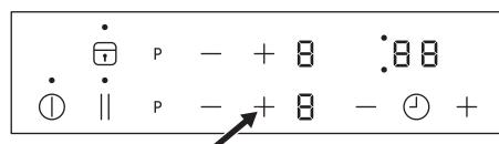
Ajuste con **—** para reducir el nivel de potencia.
